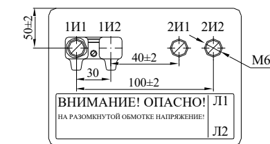
Рисунок Б.1 Трансформаторы тока ТШЛ-20-1
