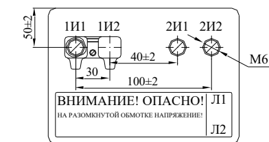
Рисунок Б.1 Трансформаторы тока ТШЛ-20-1
